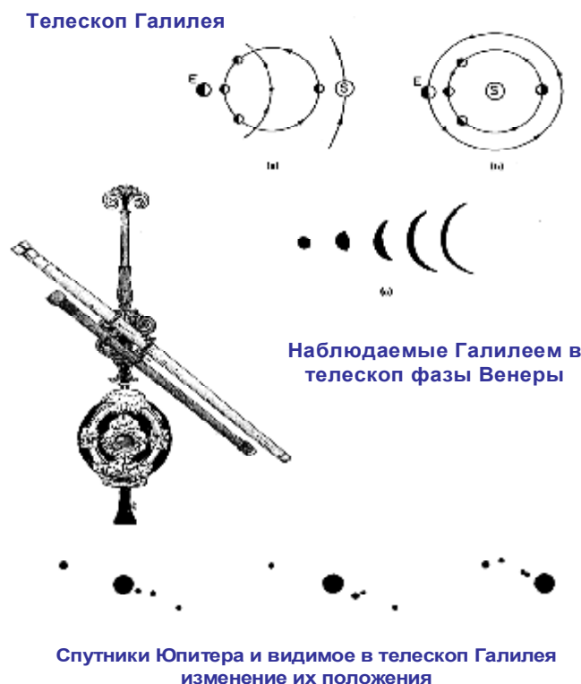
Рис. 28. На рис. внизу изображены спутники Юпитера и видимое в телескоп Галилея изменение их положения 46 , на рис. вверху показаны наблюдаемые через слабый телескоп фазы Венеры, а также сам телескоп Галилея 47 .
