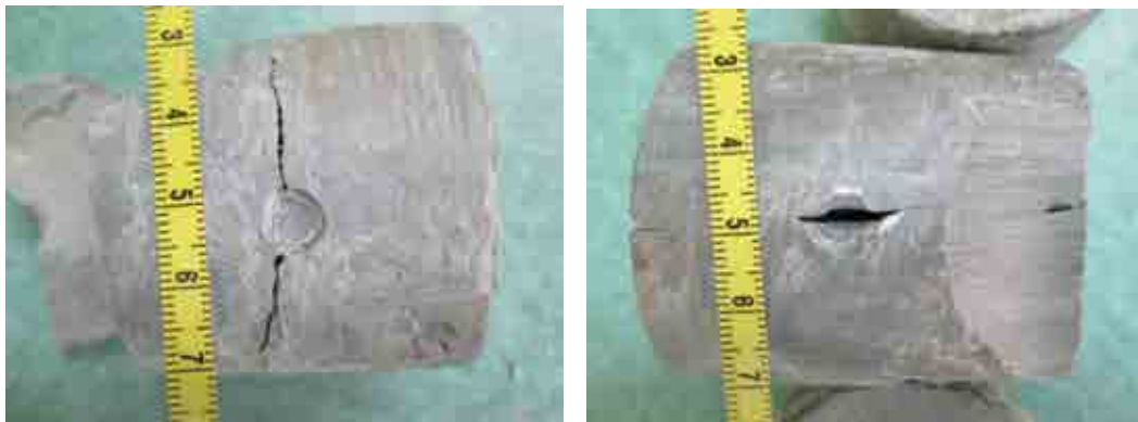
Рисунок 3.9 – Участки внедрения сферического индентора в тело образца
