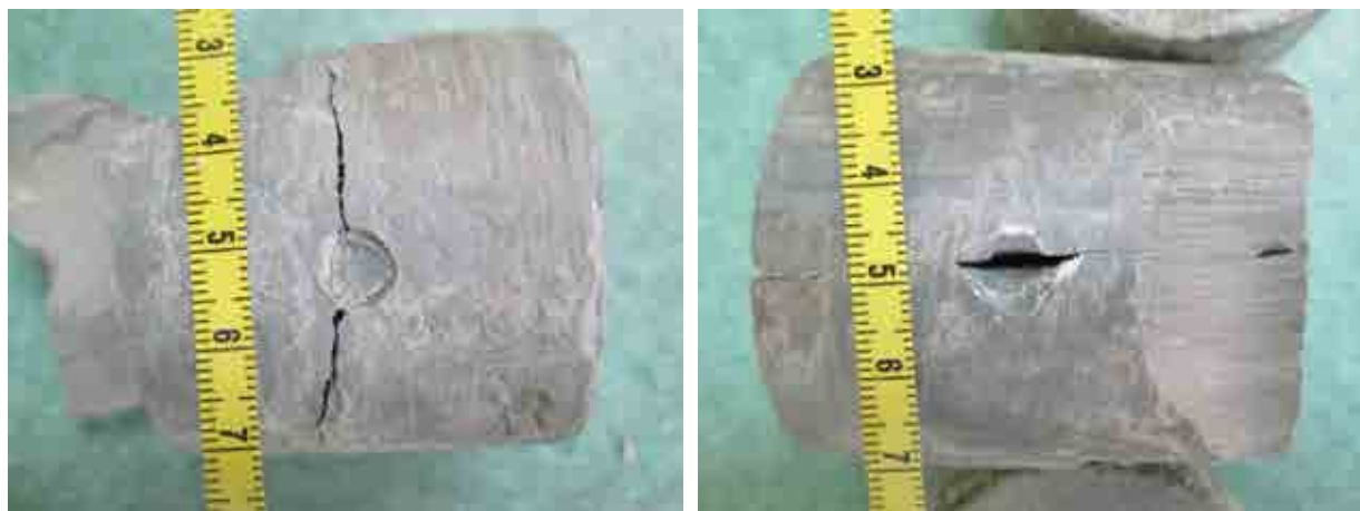
Рисунок 3.26 – Фотографии образцов протерозойской глины после их раскалывания сферическими инденторами
