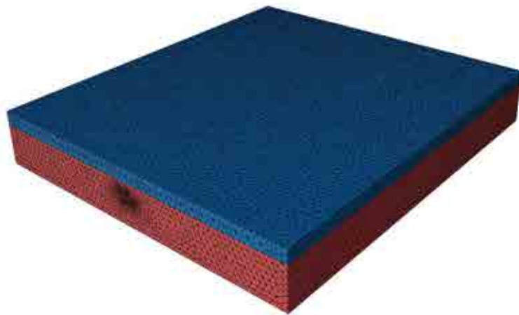
Рисунок 7.10 – Конечно-элементная модель прогноза деформаций земной поверхности при строительстве подземных сооружений станционного комплекса “Путиловская”, расположенных в протерозойских глинах
