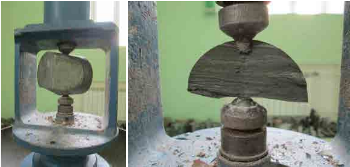
Рисунок 3.8 – Схема проведения испытания породы сферическими инденторами
