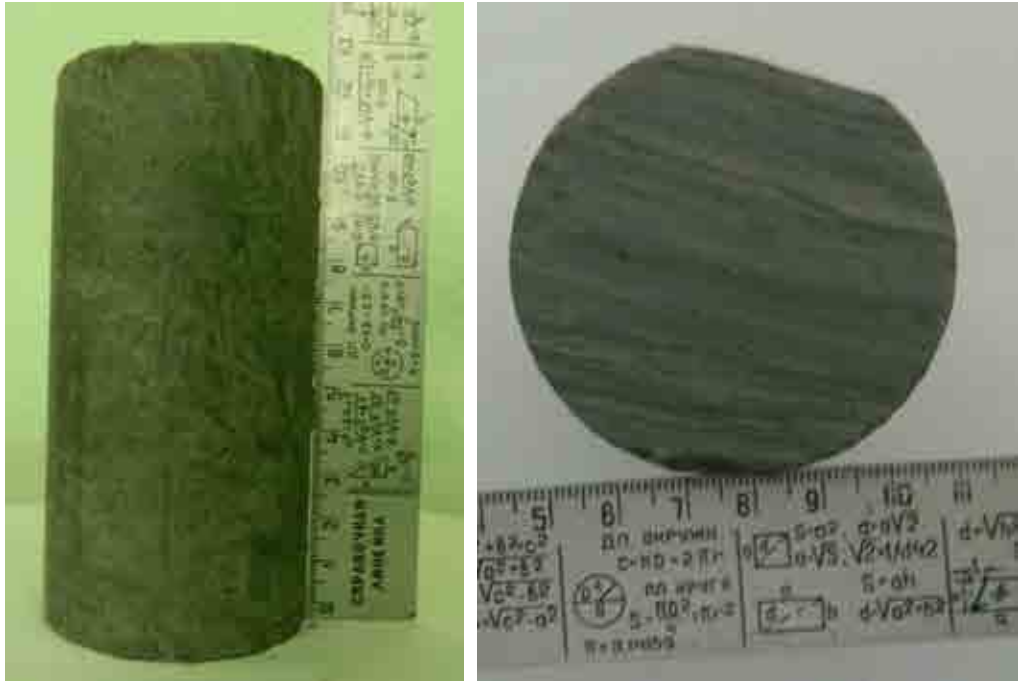
Рисунок 3.11 – Измерение размеров образца перед испытанием
