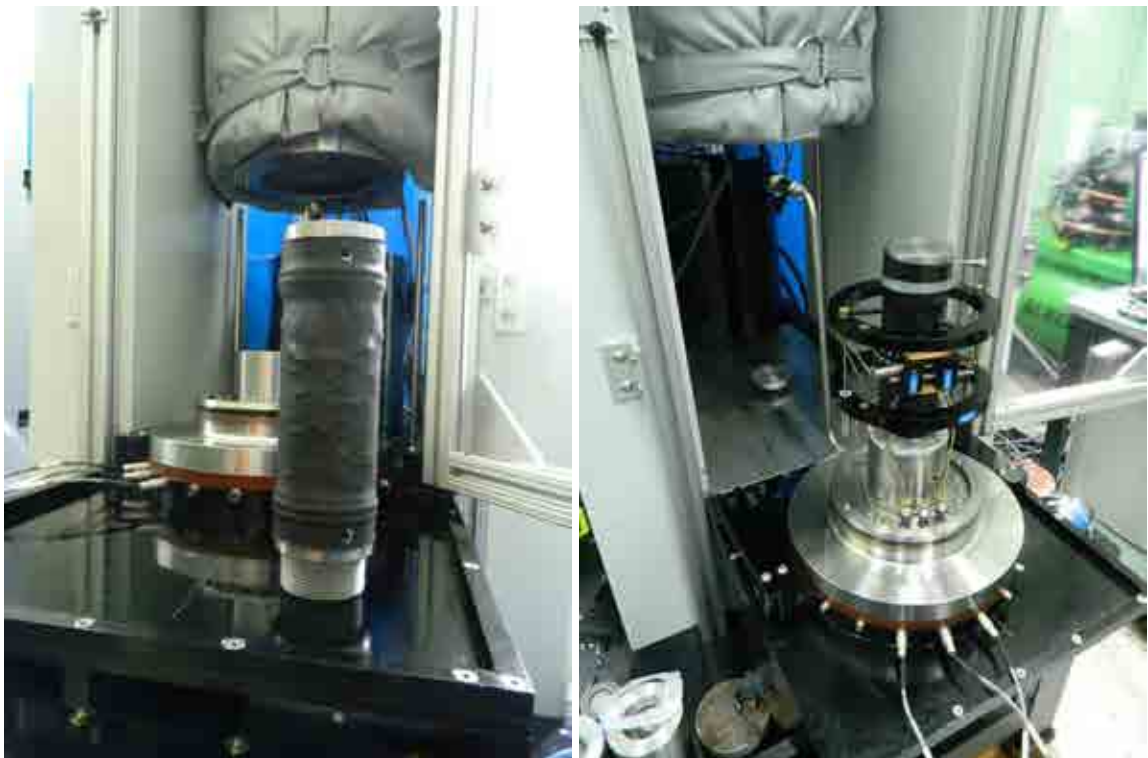
Рисунок 3.12 – Установка образца в камеру трехосного сжатия
